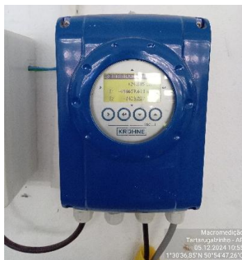
c) Macromedidor de saída registrando 24,685 L/s
