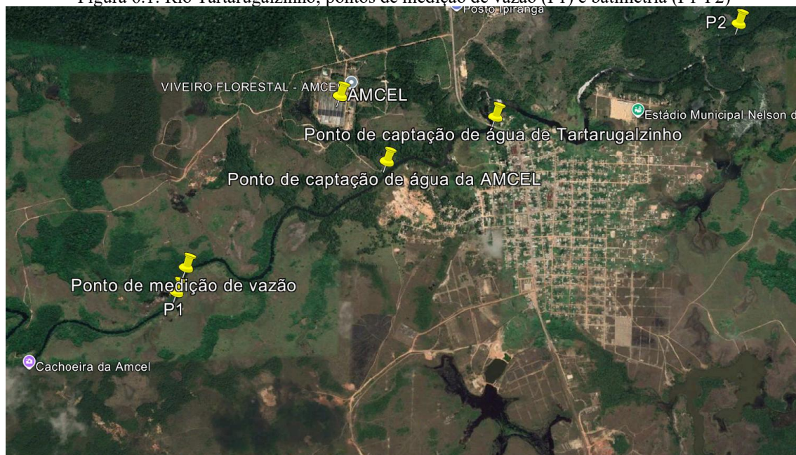
Figura 6.1: Rio Tartarugalzinho; pontos de medição de vazão (P1) e batimetria (P1-P2)
